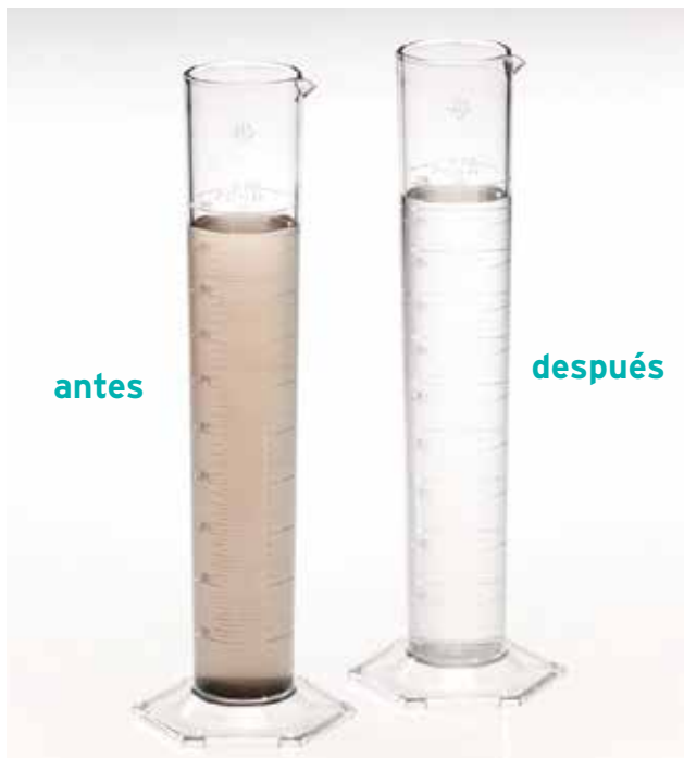
Sumideros antes y después del tratamiento con el sustrato de filtro CARBOTEC 60.
